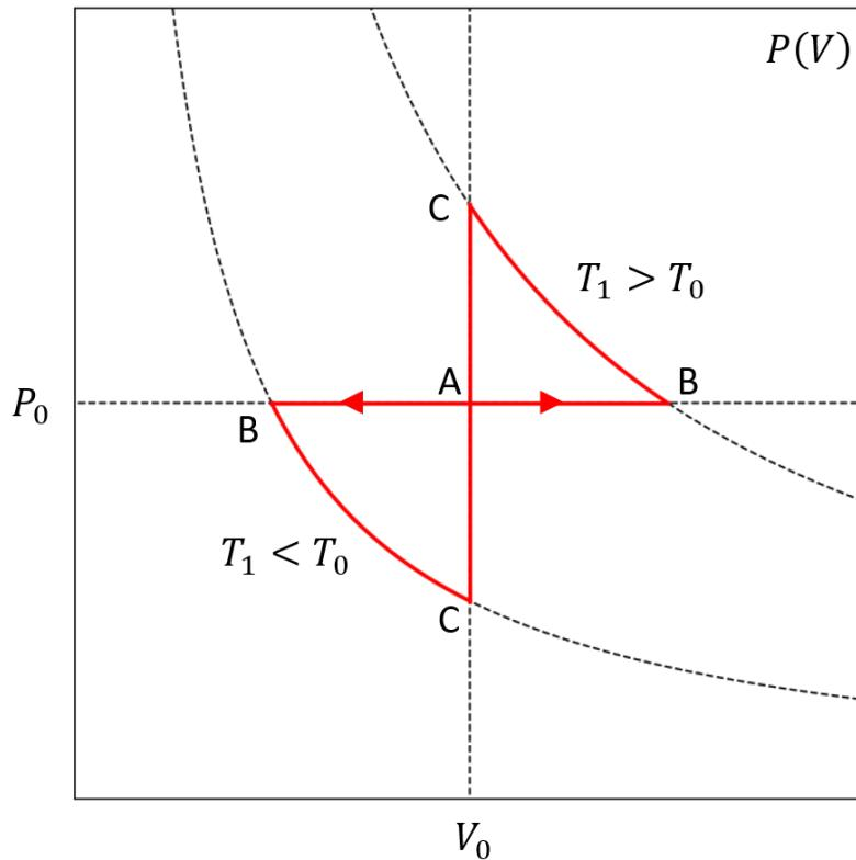
On voit graphiquement que les deux cycles sont parcourus dans le sens trigonométrique (cycle récepteur). Cela se vérifie également en regardant le signe du travail du cycle :
