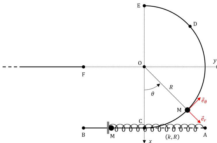
Une bille (point M de masse  $m$  supposée ponctuelle) circule sur une piste BCEF. Cette piste est constituée : d'une partie rectiligne BC de longueur  $R$ , d'un demi-cercle CE de rayon  $R$  et de centre O, et d'une seconde partie rectiligne commençant au point F (situé au dessus du point B, à gauche du point O).
